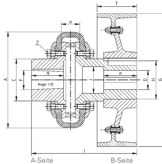
Toleranzfeld für Fertigbohrungen H7 / Range of Tolerances for Finish Bores Keyways for Fitting
