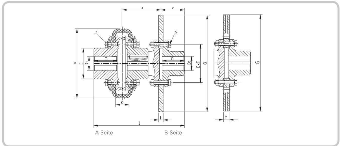
Toleranzfeld für Fertigungsbohrungen H7 / Range of Tolerances for Finish Bores Keyways for Fitting
