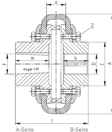
Toleranzfeld für Fertigbohrungen H7 / Range of Tolerances for Finish Bores Keyways for Fitting
