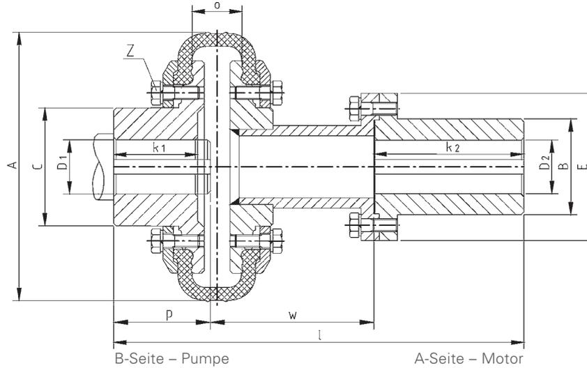
Toleranzfeld für Fertigbohrungen H7 / Range of Tolerances for Finish Bores Keyways for Fitting
