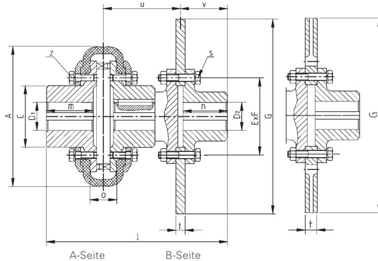
Toleranzfeld für Fertigungsbohrungen H7 / Range of Tolerances for Finish Bores Keyways for Fitting
