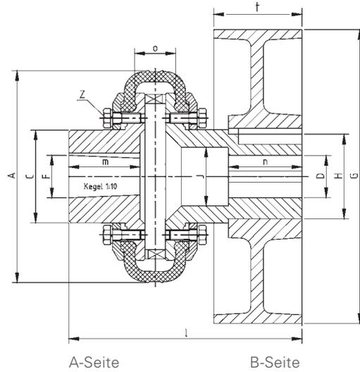
Toleranzfeld für Fertigbohrungen H7 / Range of Tolerances for Finish Bores Keyways for Fitting
